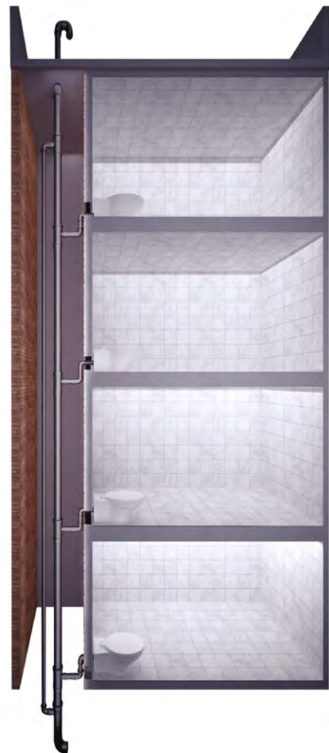
شکل ۸ سیستم فاضلاب بدون هواکش مستقل
