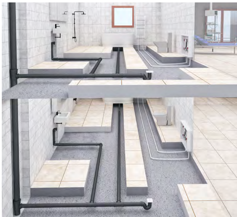
شکل ۱ نمای اجرای پلی‌تک در بیمارستان
