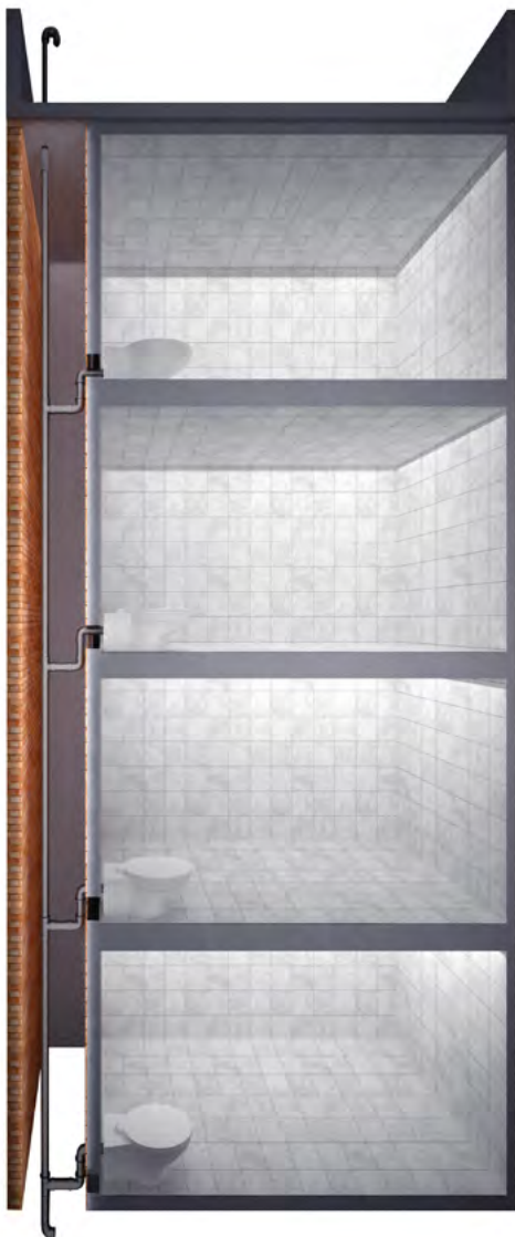
شکل ۷ سیستم فاضلاب با هواکش با قطر کمتر
